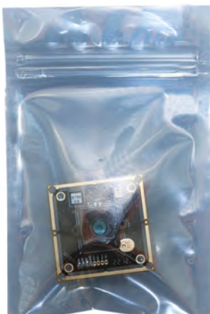
Sele a bandeja com um saco antiestático
